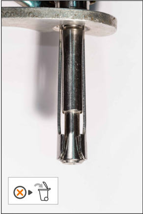
• Bent wedge plates
